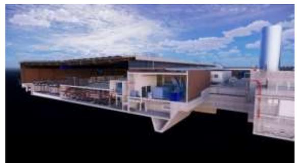
**Abbildung 6: Längsschnitte durch Abwasserbecken mit neuer Wetterschutzhalle aus BIM-Modell**
