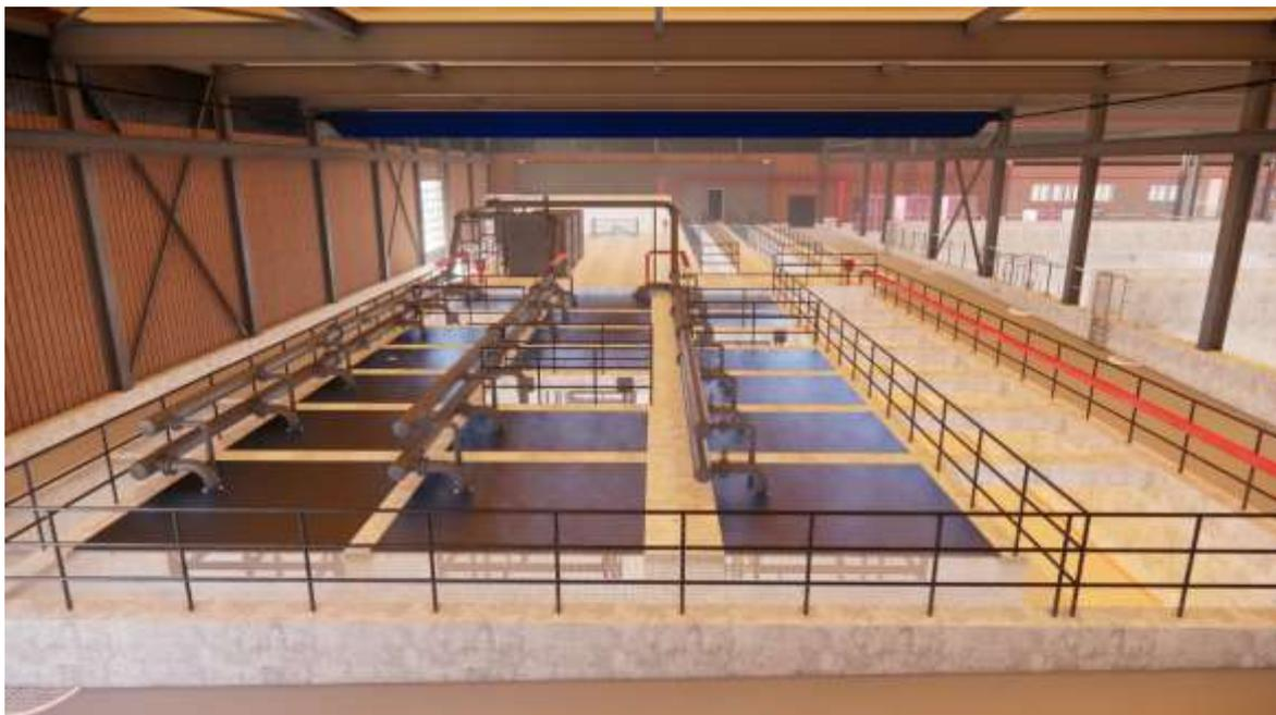
**Abbildung 11: Visualisierte Sicht in neue Wetterschutzhalle über Membranbecken (heutige Nachklärung)**
