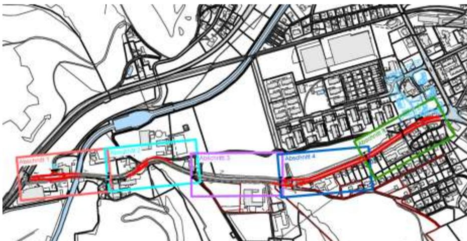
Im gesamten Perimeter ist der bestehende Belag gemäss Zustandsbeurteilung des AVT in einem ausreichend bis kritischen Zustand. Dasselbe gilt für bestehende Randabschlüsse. Fugen sind grösstenteils gerissen. Viele Steine sind beschädigt. Der Belag im Fahrbahnbereich ist im gesamten Perimeter zu ersetzen. Randabschlüsse entlang der Fahrbahn sind, wo nötig, zu ersetzen und den aktuellen Anforderungen resp. Richtlinien anzupassen.
