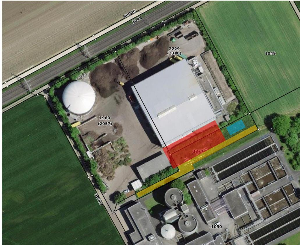
Für die Erweiterung beanspruchter Boden; rot: Halle; blau: Gasaufbereitungsanlage; gelb: Verkehrsfläche.
